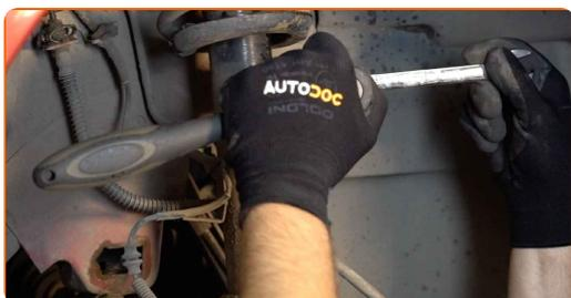
**16** Retire el enlace estabilizador de estabilidad transversal.
