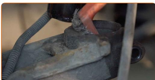
**47** Fije la pata amortiguadora en el muñón de dirección.
