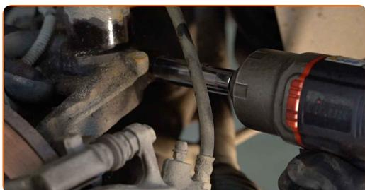
**24** Retire el perno de sujeción.
