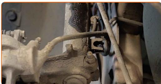
**15** Desatornille la sujeción que conecta la bieleta de barra estabilizadora al amortiguador. Usa una llave mixta del n.º 17. Utilice Torx T30. Utilice una llave de trinquete.
