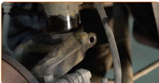
**25** Sostenga el muñón de dirección. Utilice un gato de transmisión hidráulica.
