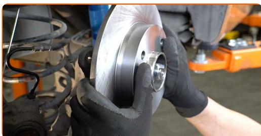
**25** Apriete la tuerca del cubo de rueda. Use un vaso de impacto del n.º 36. Utilice una llave dinamométrica. Apriételo a un par de 270 Nm.
