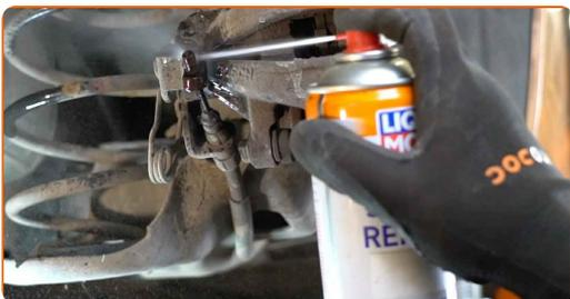
**8** Suelte el cable del freno de estacionamiento. Use alicates de bomba de agua. Utilice alicates. Use una palanca.
