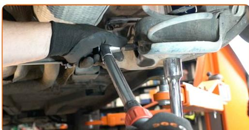
**26** Retire el soporte por debajo de la viga trasera.
