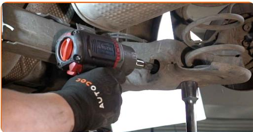
**14** Retire el perno de sujeción.
