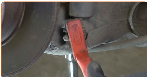
**13** Destornille la fijación inferior del amortiguador. Use un vaso de impacto del n.º E16. Utilice una llave de trinquete.
