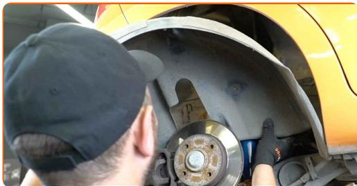
**28** Vuelva a instalar los clips de plástico del revestimiento del paso de rueda.
