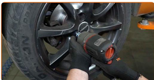
**34** Baje el automóvil y, manteniendo el orden cruzado, apriete los pernos de fijación de las ruedas. Utilice una llave de impacto para llanta # 17. Utilice una llave dinamométrica. Apriételo a un par de 100 Nm.
