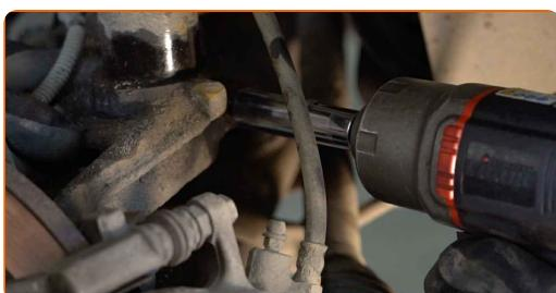
**24** Retire el perno de sujeción.
