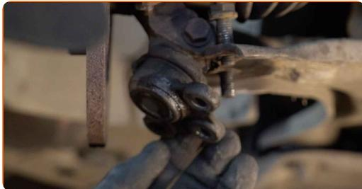
**21** Desenrosque la fijación que conecta el eje de transmisión al cubo de la rueda. Use un vaso de impacto del n.º 30.
