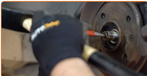
**23** Desatornille la sujeción inferior que conecta el puntal amortiguador a la mangueta de dirección. Use un vaso de impacto del n.º 16. Utilice una llave giramachos.
