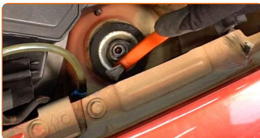
**4** Afloje la sujeción superior del soporte del amortiguador. Use Vaso HEX No. H7. Usa una llave mixta del n.º 22. Utilice una llave de trinquete.
