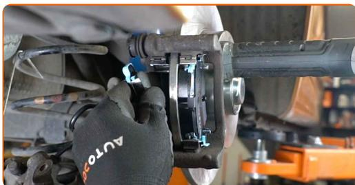
**33** Establezcan el soporte de freno y lo fijen. Usa una llave mixta del n.º 19. Use un vaso de impacto del n.º 13. Utilice una llave dinamométrica. Apriételo a un par de 30 Nm.
