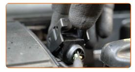
6 Saque la bobina de ignición del pozo de la bujía.
