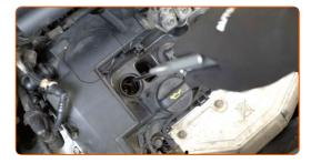
Instale la nueva bobina de ignición en el pozo de la bujía. Asegúrese de que escucha un sonido clic indicando que está bloqueado en su lugar.
