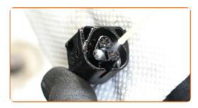
Enchufe el conector de la bobina de encendido. Asegúrese de que escucha un sonido clic indicando que está bloqueado en su lugar.
