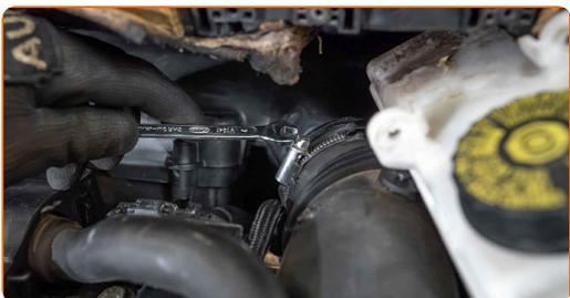
**16** Instale el depósito de líquido de frenos.
