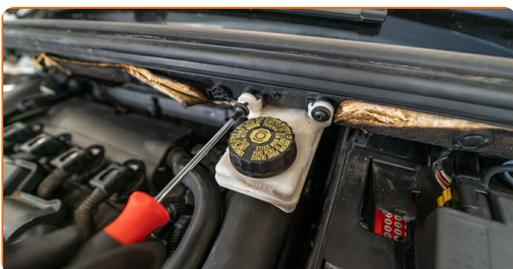
**4** Retire el depósito de líquido de frenos. Muévelo a un lado.
