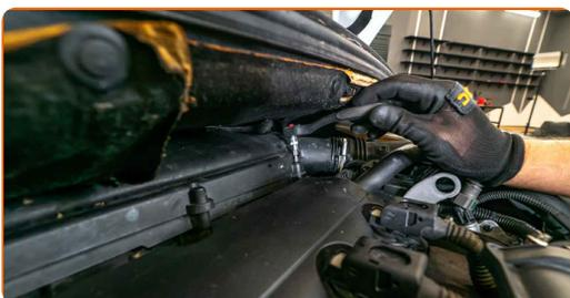
**7** Desconecte el tubo de entrada de aire de la carcasa del filtro de aire.
