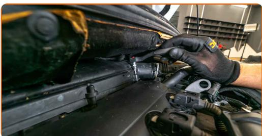
**14** Conecte el tubo de entrada de aire a la carcasa del filtro de aire.
