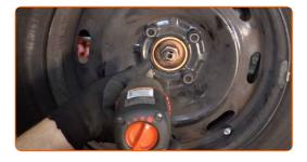
Baje el automóvil y, manteniendo el orden cruzado, apriete los pernos de fijación de las ruedas. Utilice una llave dinamométrica. Apriételo a un par de 90 Nm.
