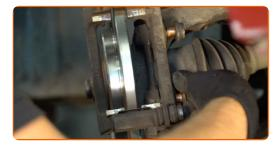
Apriete la fijación de la pinza del cáliper de freno. Utilice Torx T55. Utilice una llave dinamométrica. Apriételo a un par de 105 Nm.
