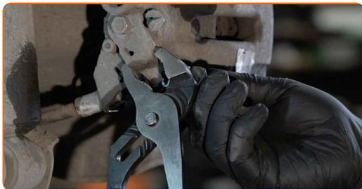
**9** Destornille la fijación del cáliper de freno. Usa una llave mixta del n.º 15. Use un vaso de impacto del n.º 13. Utilice una llave de trinquete.
