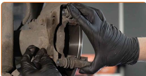
**32** Apriete la fijación de la pinza del cáliper de freno. Utilice Torx T50. Utilice una llave dinamométrica. Apriételo a un par de 53 Nm.
