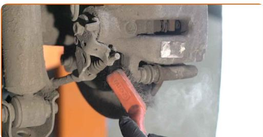
**8** Suelte el cable del freno de estacionamiento. Use alicates de bomba de agua. Utilice un destornillador plano.
