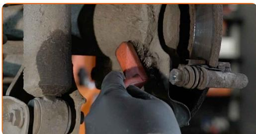
**14** Destornille la fijación de la pinza del cáliper de freno. Utilice Torx T50. Utilice una llave giramachos.
