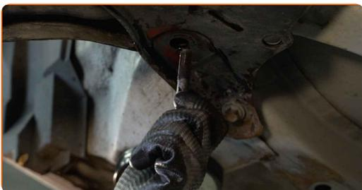
**14** Retire la sujeción delantera del brazo de control. Use un vaso de impacto del n.º 17.
