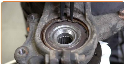
**42** Suelte el tornillo de banco y retire la maneta de dirección ensamblada con el cubo de rueda.
