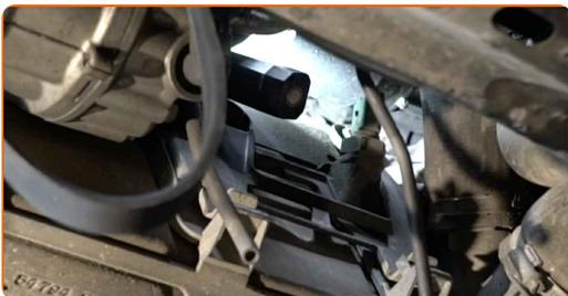
**101** Trate el conector del sensor de posición del cigüeñal. Utilice un spray de limpieza multiuso.
