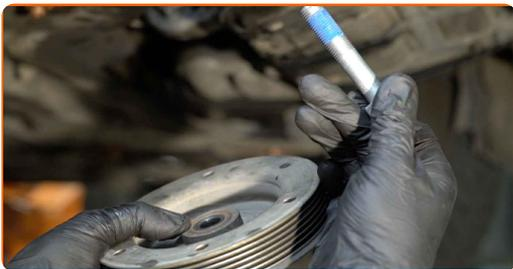
**99** Apriete la sujeción de la polea del cigüeñal. Use un vaso de impacto del n.º 22. Utilice una llave dinamométrica. Apriételo a un par de 80 Nm.+60°
