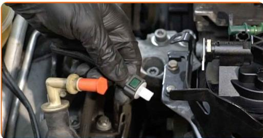
**117** Conecte las líneas de admisión del combustible al filtro de combustible y cierre las grapas de fijación.
