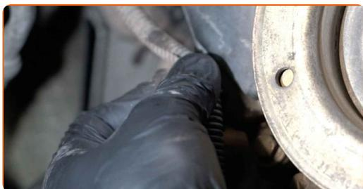
**104** Tire hacia un lado la polea tensora de la correa acanalada en V. Usa una llave mixta del n.º 15.
