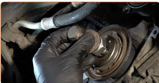
**90** Retire la herramienta de bloqueo del engranaje del cigüeñal.
