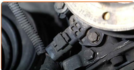
**103** Conecte el cableado del sensor de posición del cigüeñal.
