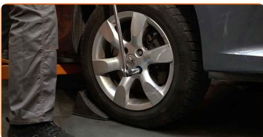
**25** Levante la parte delantera del automóvil y fije la posición sobre los pedestales.
