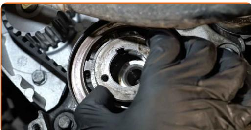
**83** Instale el perno de sujeción.
