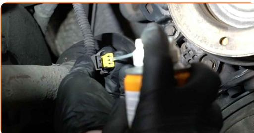
**102** Conecte el conector del sensor de posición del cigüeñal.
