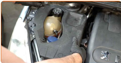
**146** Fije el depósito de refrigerante usando sus retenedores.
