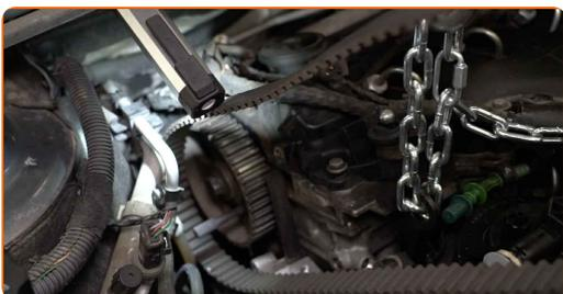
**54** Desenrosque la sujeción del rodillo tensor de la correa de distribución. Usa una llave mixta del n.º 15.
