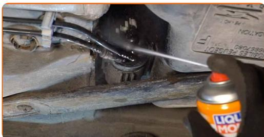
**6** Retire las líneas de combustible de la carrocería del vehículo.
