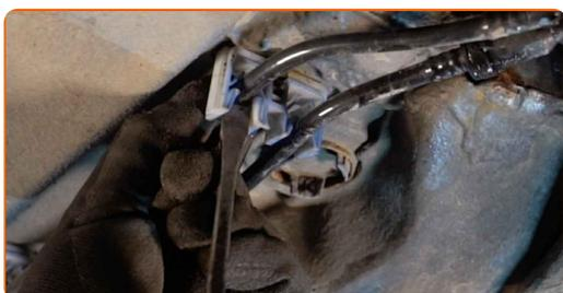
**7** Apriete los clips y separe las líneas de suministro de combustible de la carcasa del filtro de aceite. Utilice alicates para conectores de tubos de combustible. Use una palanca.
