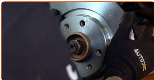
**20** Apriete la fijación del disco de freno. Utilice Torx T30. Utilice una llave dinamométrica. Apriételo a un par de 9 Nm.
