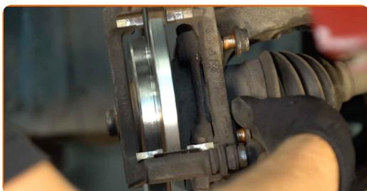
**23** Apriete la fijación de la pinza del cáliper de freno. Utilice Torx T55. Utilice una llave dinamométrica. Apriételo a un par de 105 Nm.
