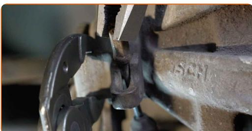
**9** Limpie las sujeciones de la pinza del freno. Use un cepillo de alambre. Utilice un spray de limpieza multiuso.
