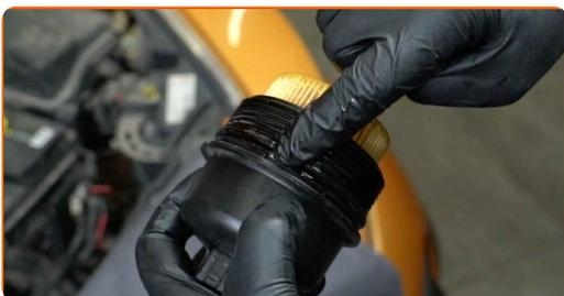
**19** Instale la tapa del cuerpo del filtro de aceite y atorníllela. Use un vaso de impacto del n.º 27. Utilice una llave dinamométrica. Apriételo a un par de 25 Nm.
