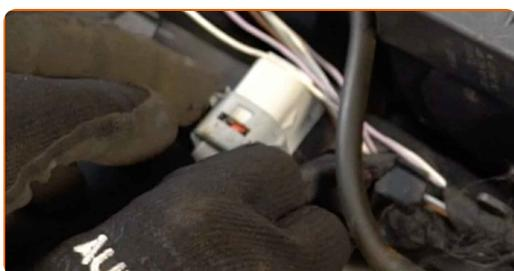
**28** Conecte la manguera de ventilación del cárter al conducto de aire.
