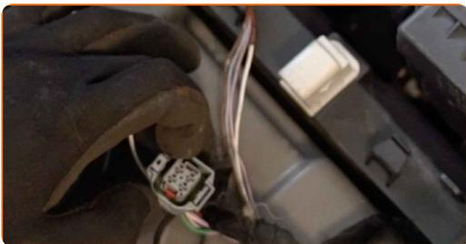
**9** Desconecte el conector del colector de admisión.
