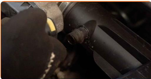
**7** Separe los conectores de la válvula del acelerador.
