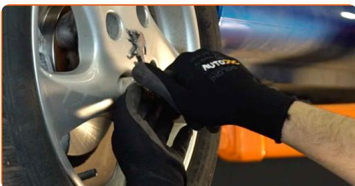
**21** Baje el automóvil y, manteniendo el orden cruzado, apriete los pernos de fijación de las ruedas. Utilice una llave dinamométrica. Apriételo a un par de 100 Nm.
