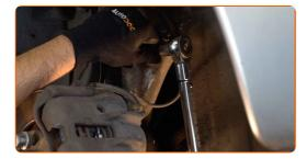
Apriete la sujeción que conecta la bieleta a la barra estabilizadora. Use un vaso de impacto del n.º 17. Utilice una llave dinamométrica. Apriételo a un par de 40 Nm.
