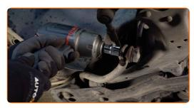
Desatornille la sujeción que conecta la bieleta de barra estabilizadora al amortiguador. Use un vaso de impacto del n.º 17.
