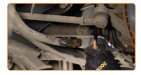
Apriete la sujeción que conecta la bieleta de barra estabilizadora al amortiguador. Use un vaso de impacto del n.º 17. Utilice una llave dinamométrica. Apriételo a un par de 40 Nm.
