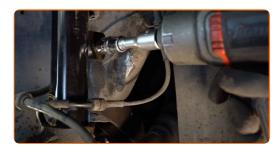
Retire el enlace estabilizador de estabilidad transversal.
