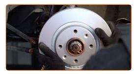
Apriete la fijación del disco de freno. Utilice un destornillador Phillips. Utilice una llave dinamométrica. Apriételo a un par de 9 Nm.
