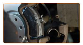
Establezcan el soporte de freno y lo fijen. Usa una llave mixta del n.º 13. Usa una llave mixta del n.º 15. Utilice una llave dinamométrica. Apriételo a un par de 27 Nm.
