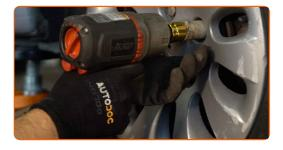
Baje el automóvil y, manteniendo el orden cruzado, apriete los pernos de fijación de las ruedas. Utilice una llave dinamométrica. Apriételo a un par de 100 Nm.
