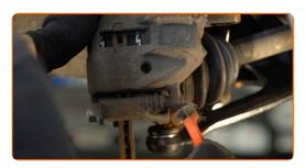
Destornille la fijación del cáliper de freno. Usa una llave mixta del n.º 13. Usa una llave mixta del n.º 15.
