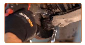
Retire el perno de sujeción.
