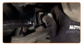
Atornille la fijación trasera de la palanca. Usa una llave mixta del n.º 13. Use un vaso de impacto del n.º 16. Utilice una llave de trinquete.
