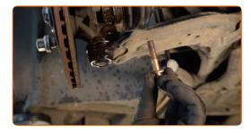
Desconecte el brazo inferior del muñón de dirección. Use una palanca.
