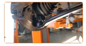
lnstale el perno de sujeción.
