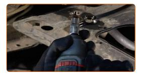
Retire la sujeción trasera del brazo de control.
