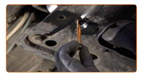
20 Instale el tornillo de sujeción delantero del brazo.
