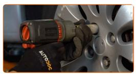
Baje el automóvil y, manteniendo el orden cruzado, apriete los pernos de fijación de las ruedas. Utilice una llave dinamométrica. Apriételo a un par de 100 Nm.
