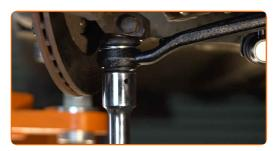
Apriete la sujeción delantera que conecta el brazo de control al subchasis. Use un vaso de impacto del n.º 18. Utilice una llave dinamométrica. Apriételo a un par de 74 Nm.
