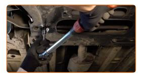
Conecte la palanca inferior al muñón de dirección.
