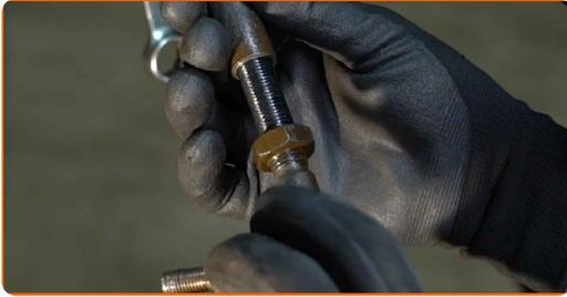
12 Limpie los asientos de montaje del extremo de la barra de acoplamiento. Use un cepillo de alambre. Utilice un spray de limpieza multiuso.
