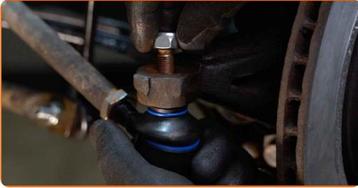
**16** Atornille la tuerca de sujeción que conecta el extremo de la barra de acoplamiento a la mangueta de dirección. Use un vaso de impacto del n.º 17. Utilice una llave de trinquete.
