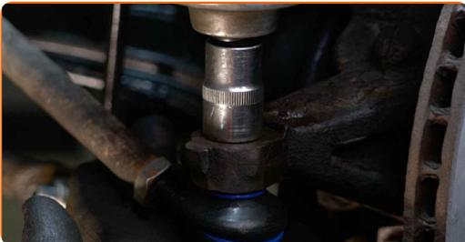
**17** Coloque el extremo de la barra de dirección en la posición correcta y fíjelo con la tuerca de seguridad. Utilice un calibrador Vernier. Usa una llave mixta del n.º 16. Usa una llave mixta del n.º 22.
