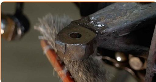
13 Trate los asientos de montaje del extremo de la barra de acoplamiento. Use grasa de cobre.
