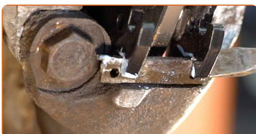
**15** Instale el perno de retención de la pastilla de freno.
