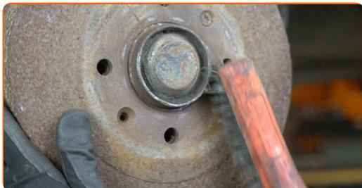
**7** Desenrosque las sujeciones del tambor del freno. Utilice Torx T30. Utilice un destornillador de impacto.
