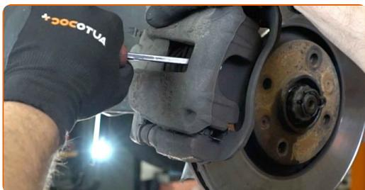
**13** Retire el soporte de freno. Use una palanca.
