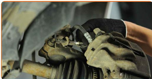
**11** Desconecte el cable sensor de desgaste de las pastillas de freno.
