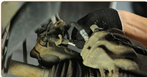
**25** Trate la superficie donde el disco del freno entra en contacto con la llanta de la rueda. Utilice grasa cerámica para altas temperaturas.
