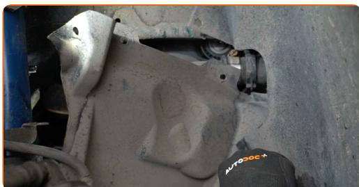
**10** Suelte las sujeciones de la tubería de refrigerante.
