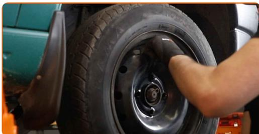
**8** Desatornille y retire las sujeciones de la cubierta del paso de rueda. Utilice una herramienta de extracción de clips. Utilice un destornillador Phillips.
