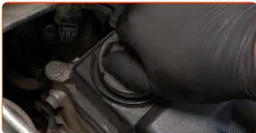
**44** Haga funcionar el motor durante unos minutos. Después de que se apague la luz de advertencia de presión del aceite, detenga el motor.
