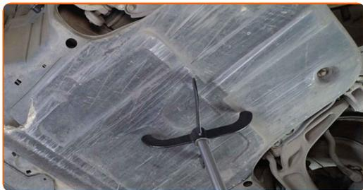
**35** Apriete las sujeciones del protector antisalpicaduras del motor. Use un vaso de impacto del n.º 10. Utilice una llave de trinquete.
