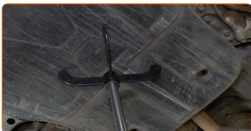
**7** Desenrosque las sujeciones del protector antisalpicaduras del motor. Use un vaso de impacto del n.º 10. Utilice una llave de trinquete.
