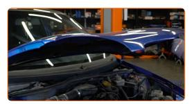
Utilice un protector de aletas para evitar daños en la pintura y en las partes de plástico del automóvil.
