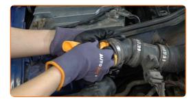
6 Suelte los clips de la cubierta del filtro de aire.
