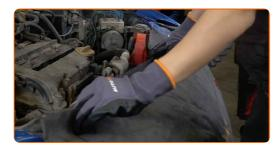
Afloje la abrazadera de sujeción que conecta el conducto de aire a la carcasa del filtro de aire. Utilice un destornillador Phillips.
