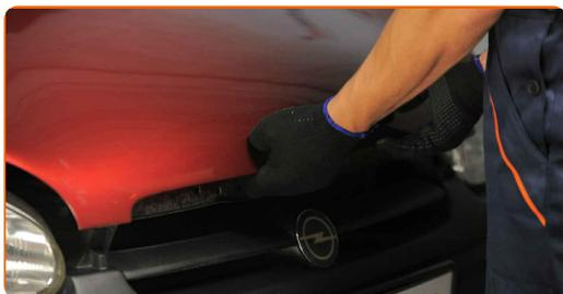
**12** Utilice un protector de aletas para evitar daños en la pintura y en las partes de plástico del automóvil.
