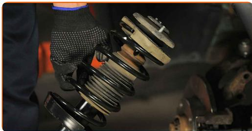
**35** Atornillen la fijación superior de la cazoleta de la pata amortiguadora.
