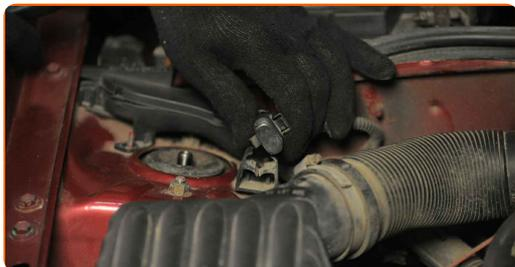
**14** Desenrosque las sujeciones del soporte del arnés de cables del motor. Use un vaso de impacto del n.º 10. Utilice una llave de trinquete.
