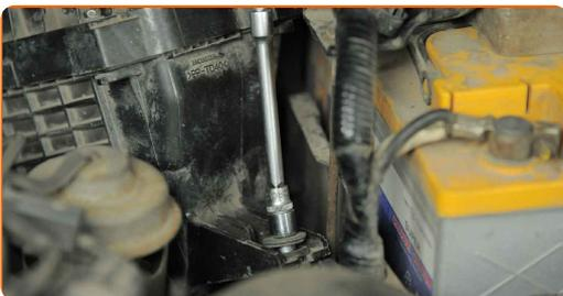
**19** Conecte el tubo de entrada de aire a la carcasa del filtro de aire.
