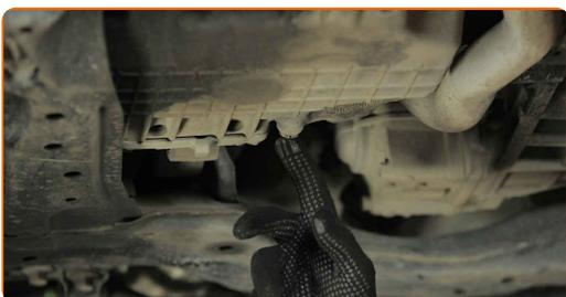
**4** Destornille el tapón de desagüe. Use un vaso de impacto del n.º 17. Utilice una llave de trinquete.
