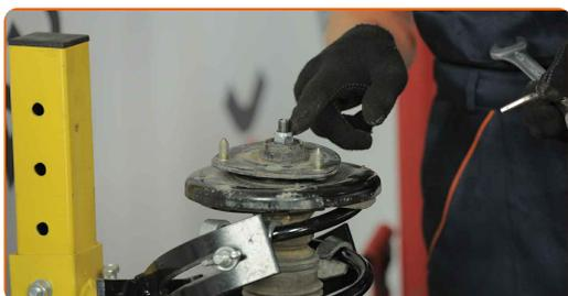
**27** Destornille la tuerca de la varilla de la pata amortiguadora. Usa una llave mixta del n.º 19. Use Vaso HEX No. H7. Utilice una llave de trinquete.
