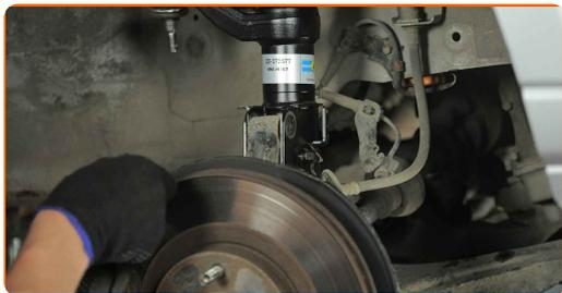
**44** Instale los pernos de sujeción (2 piezas). Utilice una llave de trinquete.
