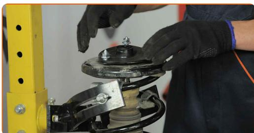
**32** Apriete la tuerca de la varilla de la pata amortiguadora. Use una llave mixta del n.º 19. Use Vaso HEX No. H7. Utilice una llave dinamométrica. Apriételo a un par de 44 Nm.
