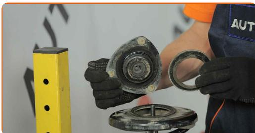
Sustitución: copelas del amortiguador - Honda CR-V II. AUTODOC recomienda:
