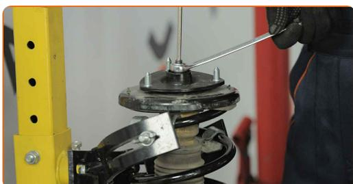
Sustitución: copelas del amortiguador - Honda CR-V II. Consejo:
