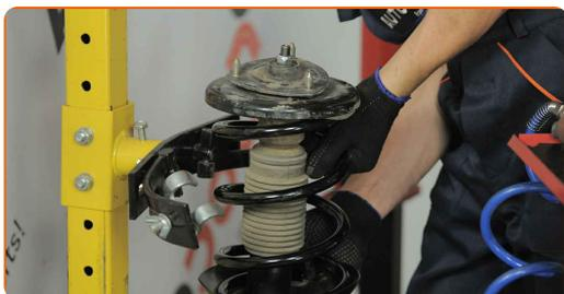
Sustitución: copelas del amortiguador - Honda CR-V II. Consejo de los expertos de AUTODOC:
