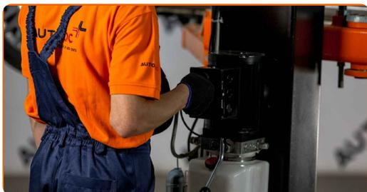
**43** Fije la pata amortiguadora en el muñón de dirección.
