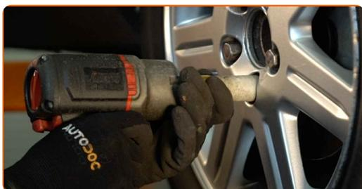
**58** Baje el automóvil y, manteniendo el orden cruzado, apriete los pernos de fijación de las ruedas. Utilice una llave de impacto para llanta # 19. Utilice una llave dinamométrica. Apriételo a un par de 108 Nm.
