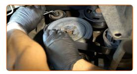
Vuelva a colocar la polea tensora en su posición inicial. Usa una llave mixta del n.º 15.
