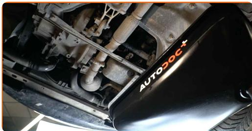
**7** Limpie el área del orificio de drenaje de la bandeja de aceite. Use un cepillo de alambre. Utilice un spray de limpieza multiuso.
