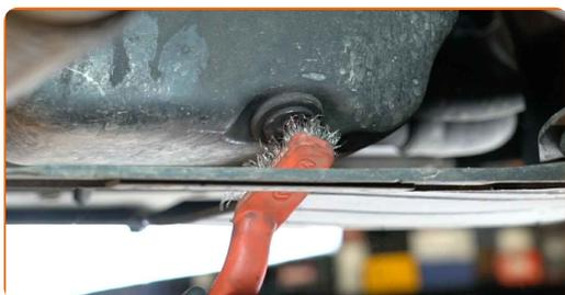
**8** Destornille el tapón de desagüe. Utilice Torx T45. Utilice una llave de trinquete.
