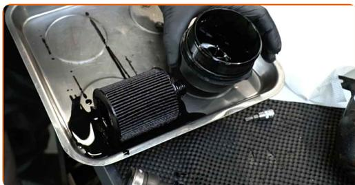
**21** Retire la junta tórica de la tapa del filtro de aceite. Utilice un destornillador plano.
