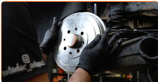
**20** Apriete las sujeciones del tambor del freno. Utilice Torx T30. Utilice una llave dinamométrica. Apriételo a un par de 4 Nm.
