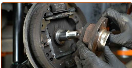
**13** Limpie el asiento de montaje del cojinete del cubo (buje). Use un cepillo de alambre. Utilice un spray de limpieza multiuso.
