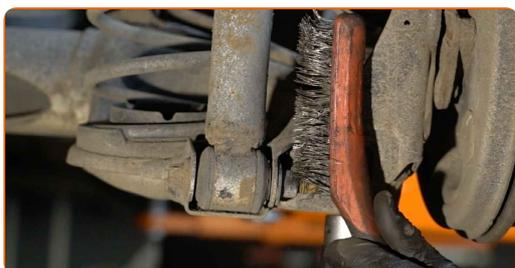
**8** Destornille la fijación inferior del amortizador. Use un vaso de impacto del n.º E18. Utilice una llave giramachos.
