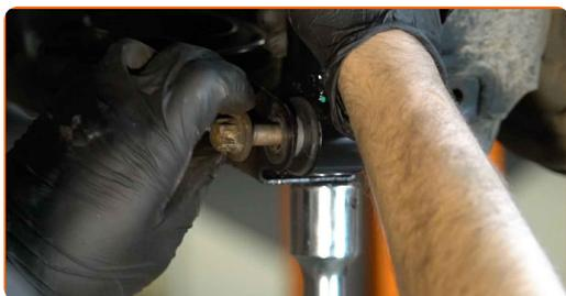
**23** Atornille la sujecion inferior del amortiguador. Use un vaso de impacto del n.º E18. Utilice una llave de trinquete.
