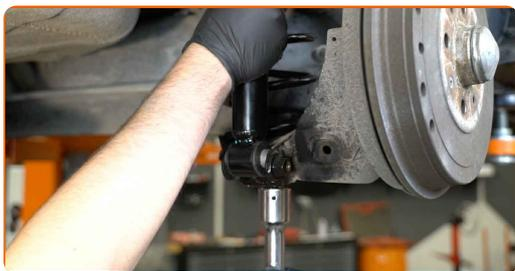
**22** Instale el perno de sujeción.
