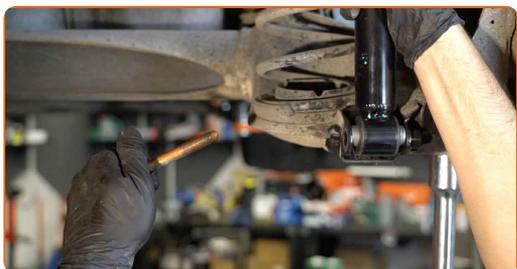
**10** Separe la parte inferior del amortiguador.
