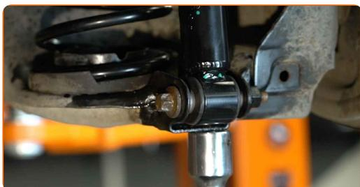
**25** Apriete la fijación inferior del amortiguador. Use un vaso de impacto del n.º E18. Utilice una llave dinamométrica. Apriételo a un par de 90 Nm.
