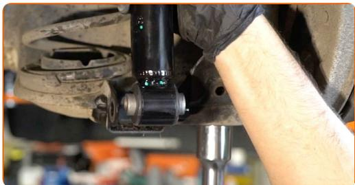
**11** Retire el soporte por debajo de la viga trasera.
