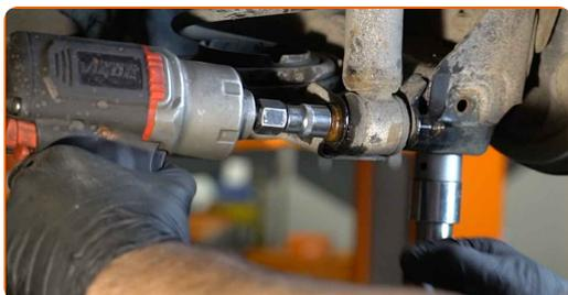
**15** Retire el perno de sujeción.
