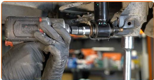
**9** Retire el perno de sujeción.
