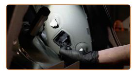
Desenrosque las sujeciones que conectan la luz trasera con la carrocería del coche.
