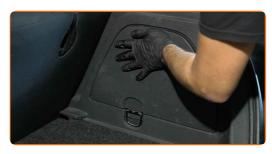
Instale los clips del revestimiento de la parte lateral del maletero.
