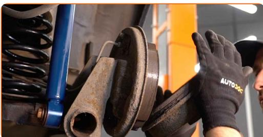
**10** Limpie el asiento de montaje del cojinete del cubo (buje). Utilice un spray de limpieza multiuso.
