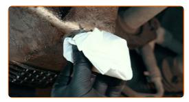
Atornille en el nuevo tapón de drenaje y apriételo. Utilice una llave de vaso de cabeza cuadrada n.º 8. Utilice una llave dinamométrica. Apriételo a un par de 28 Nm.
