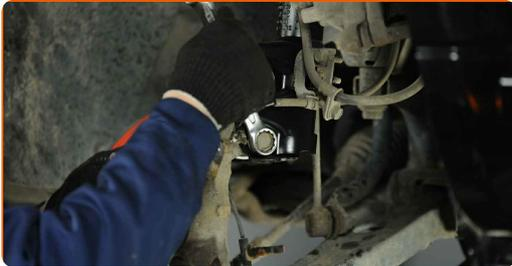
**46** Tratar las acanaladuras de la junta homocinética del eje de transmisión. Use un cepillo de alambre. Use el aerosol WD-40.
