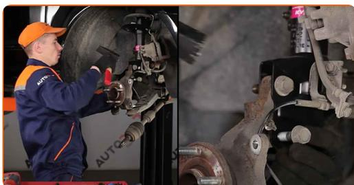
**30** Desconecte el muñón de dirección de la pata amortiguadora.
