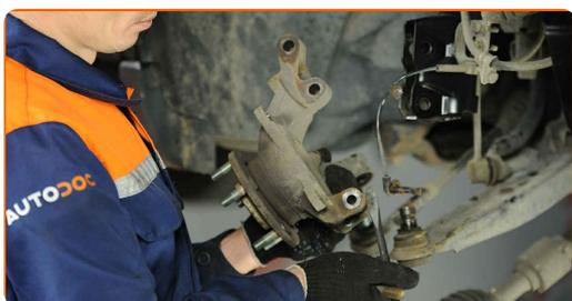
**32** Saque el cubo de rueda del muñón de dirección. Utilice un juego de cubos y rodamientos. Utilice un martillo.
