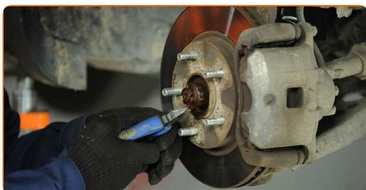
**7** Limpie el tornillo de sujeción del eje de transmisión. Use un cepillo de alambre. Use el aerosol WD-40.
