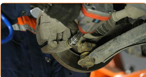
**65** Trate la sujeción que conecta el extremo de la barra de acoplamiento a la mangueta de dirección. Trate las sujeciones de la mangueta de dirección. Trate las sujeciones del soporte de la pinza del freno. Trate las sujeciones que conectan el brazo de control a la mangueta de dirección. Use grasa de cobre.
