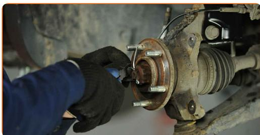
**56** Conecte el cableado del sensor ABS.
