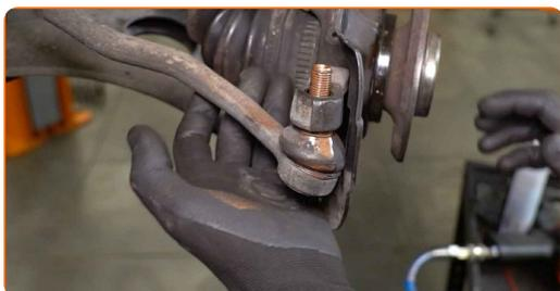
**59** Apriete la tuerca de fijación que conecta el extremo de la barra de acoplamiento a la mangueta de dirección. Usa una llave mixta del n.º 18. Utilice una llave dinamométrica. Apriételo a un par de 75 Nm.
