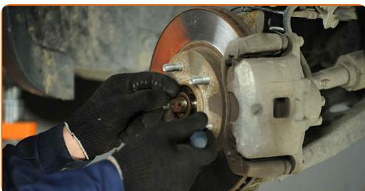
**10** Limpie las sujeciones del soporte de la pinza del freno. Use un cepillo de alambre. Use el aerosol WD-40.
