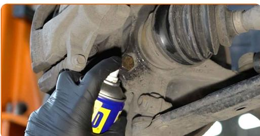
**11** Desenrosque las sujeciones del soporte de la pinza de freno. Use un vaso de impacto del n.º 18. Utilice una llave giramachos. Utilice una llave de trinquete.
