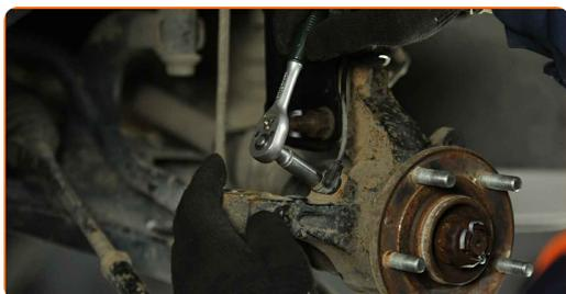
**58** Conecte la punta de la barra de dirección al muñón de dirección.
