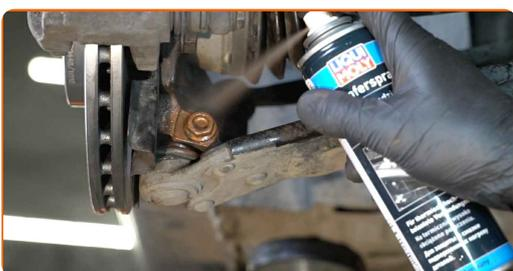
**66** Trate la superficie donde el disco del freno entra en contacto con la llanta de la rueda. Utilice grasa cerámica.
