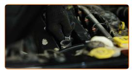
Desatornille las sujeciones de las bobinas del encendido. Utilice Torx T30. Utilice una llave de trinquete.
