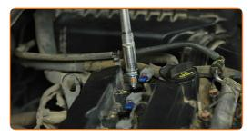
Atornille las buujías nuevas y apriételas. Use el vaso de bujía # 16. Utilice una llave dinamométrica. Apriételo a un par de 27 Nm.
