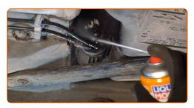
Retire las líneas de combustible de la carrocería del vehículo.
