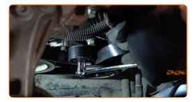
Coloque la correa acanalada en V en la polea tensora.
