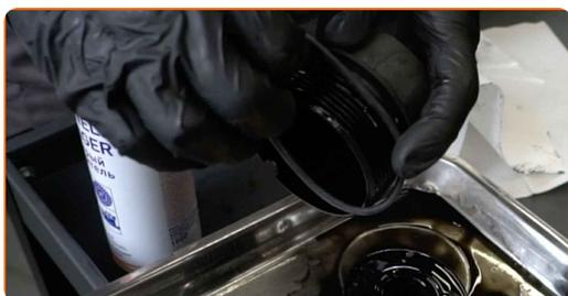
**17** Instale el nuevo filtro de aceite en el asiento de montaje de la cubierta del filtro.
