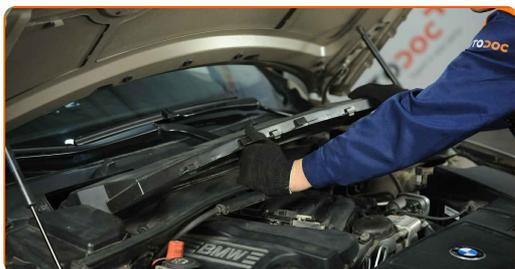
**5** Suelte los clips de la cubierta del filtro del habitáculo.
