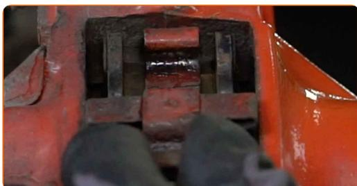
**11** Separe las pastillas de freno. Use una palanca (2 piezas).
