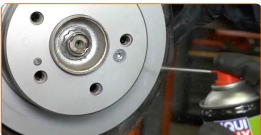
**18** Trate la superficie donde el disco del freno entra en contacto con la llanta de la rueda. Utilice grasa cerámica.
