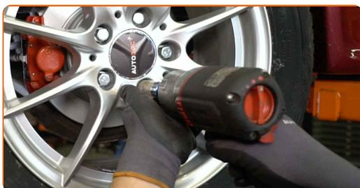
**21** Baje el automóvil y, manteniendo el orden cruzado, apriete los pernos de fijación de las ruedas. Utilice una llave de impacto para llanta # 17. Utilice una llave dinamométrica. Apriételo a un par de 110 Nm.
