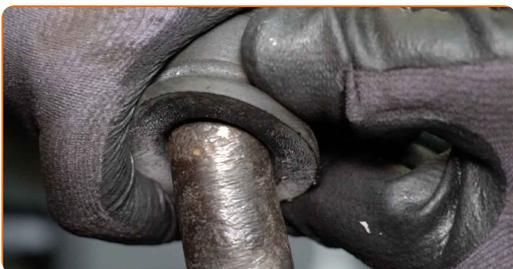
**14** Limpie los soportes de los casquillos de la barra estabilizadora. Use un cepillo de alambre. Utilice un spray de limpieza multiuso.
