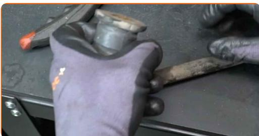
**12** Limpie los asientos de montaje de los cojinetes del estabilizador. Use un cepillo de alambre. Utilice un spray de limpieza multiuso.
