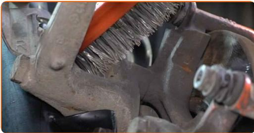
**16** Desenrosque las sujeciones del soporte de la pinza de freno. Use un vaso de impacto del n.º 19. Utilice una llave de trinquete.
