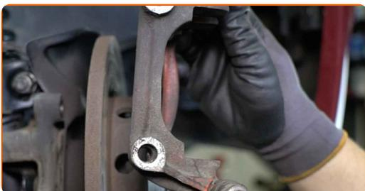
**19** Limpie la sujeción del disco de freno. Use un cepillo de alambre. Use el aerosol WD-40.
