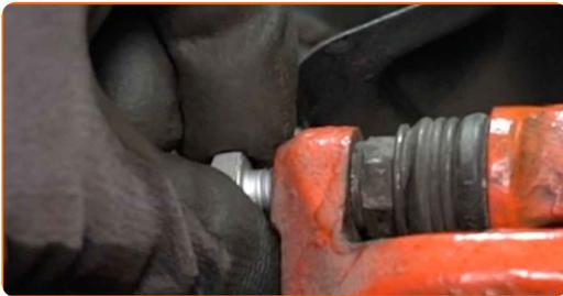
**38** Apriete las sujeciones de la pinza del freno. Usa una llave mixta del n.º 15. Use un vaso de impacto del n.º 13. Utilice una llave dinamométrica. Apriételo a un par de 35 Nm.
