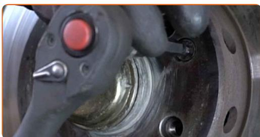
**21** Retire el perno de sujeción.
