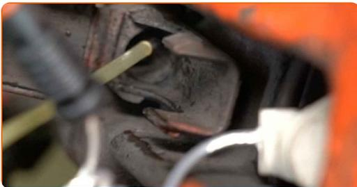
**40** Una el conector del sensor de desgaste de las pastillas de freno.
