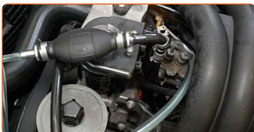
**15** Apriete la abrazadera de sujeción del tubo del filtro de combustible. Utilice un destornillador Phillips.
