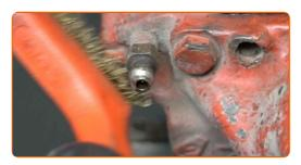
Afloje el tornillo de purgado de frenos. Use un vaso de impacto del n.º 9. Utilice una llave de trinquete.
