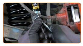
Limpie el asiento de montaje del latiguillo de freno en la pinza de freno. Use un cepillo de alambre. Use el aerosol WD-40.
