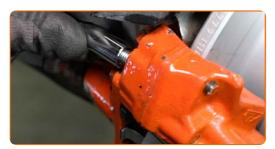
Conecte la tapa del tornillo de purga de la pinza de freno.
