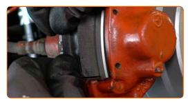
Sujete el latiguillo del freno con una abrazadera de latiguillo de freno.
