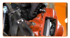
Apriete las sujeciones de la pinza del freno. Use un vaso de impacto del n.º 17. Utilice una llave dinamométrica. Apriételo a un par de 65 Nm.
