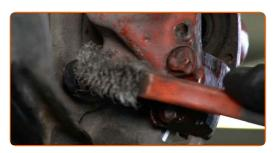
Desenrosque las sujeciones de la pinza de freno. Use un vaso de impacto del n.º 17. Utilice una llave de trinquete.
