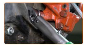
Apriete la sujeción que conecta el tubo de freno a la pinza de freno. Usa una llave mixta del n.º 14. Utilice una llave dinamométrica. Apriételo a un par de 18 Nm.
