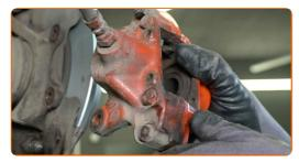
Desenrosque el latiguillo de freno de la pinza de freno.
