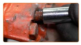
Desenrosque las sujeciones que unen las dos partes de la pinza de freno. Use un vaso de impacto del n.º 14. Utilice una llave de trinquete.
