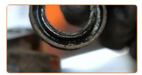
Retire los pistones de la pinza de freno. Use alicates de bomba de agua.
