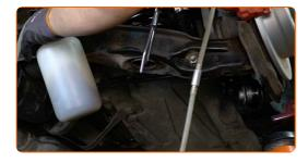
Retire la abrazadera del latiguillo del freno.
