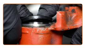
Instale los anillos de retención del guardapolvo.
