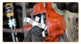
Separe las pastillas de freno. Use una palanca (2 piezas).
