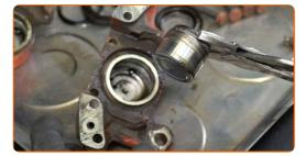
Retire las juntas tóricas de pistón. Utilice un destornillador plano.
