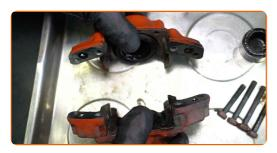
Retire las juntas tóricas. Utilice un destornillador plano.
